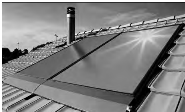
Bei der thermischen Solaranlage nimmt der Kollektor die Energie des Sonnenlichts auf und wandelt sie in Wärme um. Die Flüssigkeit im Kollektor transportiert die Wärme zum Wasserspeicher. Über einen Wärmetauscher wird die Sonnenwärme an den Speicher abgegeben und für die Erwärmung des Brauchwassers oder die Zentralheizung genutzt (© Fotoautor: Ernst Schweizer AG, Hedingen).
